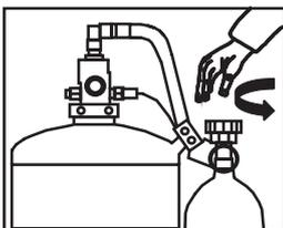
Pistole aus der Halterung nehmen und Schlauch knickfrei auslegen. Druckluftflasche ganz aufdrehen.
