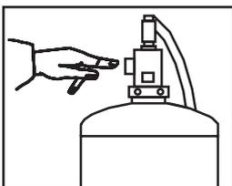
Durch Schieben des Bolzens bei Bedarf von Nass- auf Trockenschaum umstellen.
